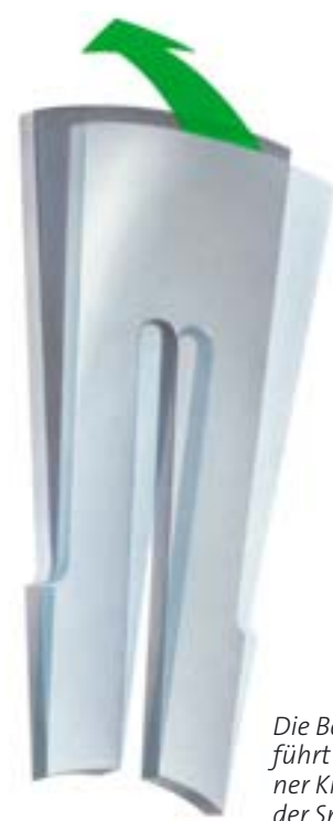
Die axial ausgeübte Betätigungskraft bewirkt eine elastische Veränderung des Kegelwinkels und damit des Durchmessers der Spannscheibe
