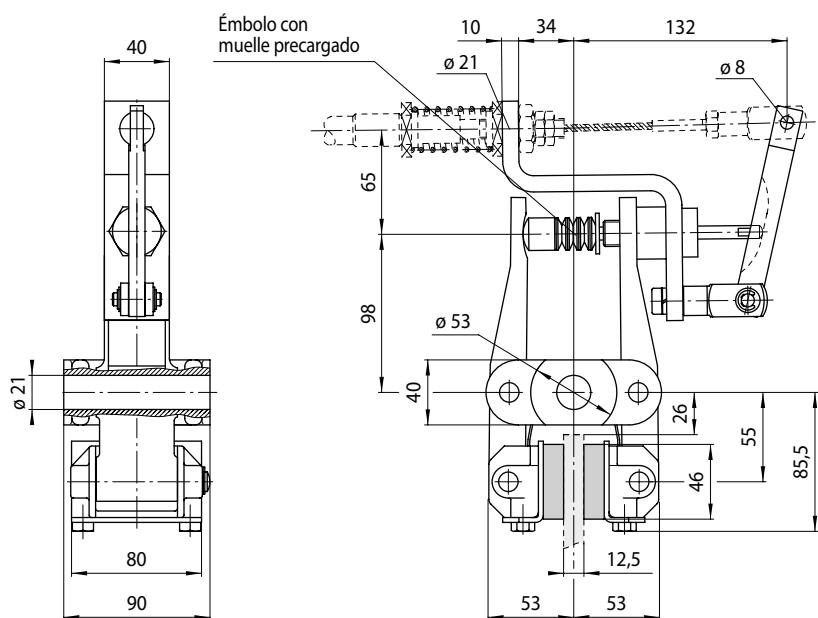
Las cotas entre paréntesis, se dan con el máximo desgaste de las zapatas.
