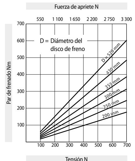
Los pares de frenado que se muestran en la tabla se basan en un coeficiente de fricción teórico de 0,4.
