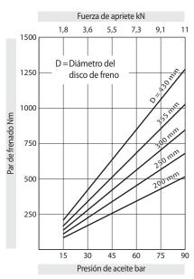
Los pares de frenado que se muestran en el diagrama se basan en un coeficiente de fricción teórico de 0,3.
