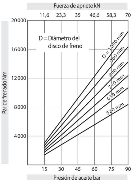
Los pares de frenado que se muestran en el diagrama se basan en un coeficiente de fricción teórico de 0,3.
